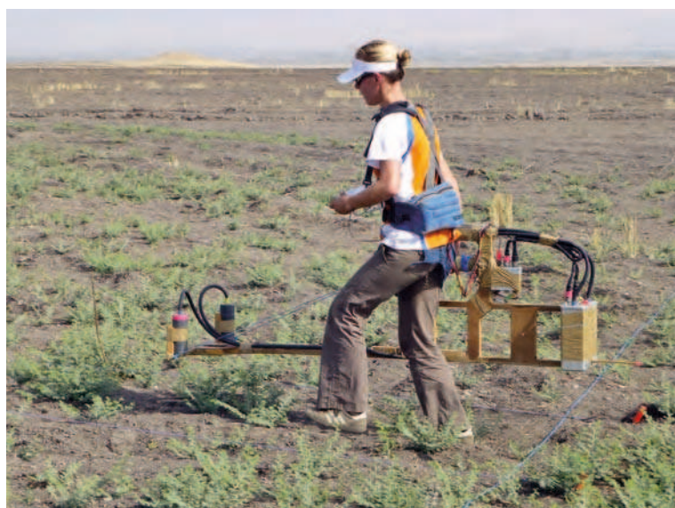
Ina Hofmann unterwegs mit dem Magnetometer (Foto: BLfD, Jörg Faßbinder)
